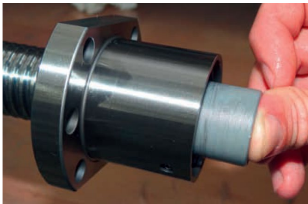
4.11. ábra: Az anya leszerelése szerelőhüvely segítségével
